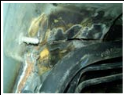
Det här är golvet under bilen. Här satt silikon-massa täckt över skarven på karossen.
