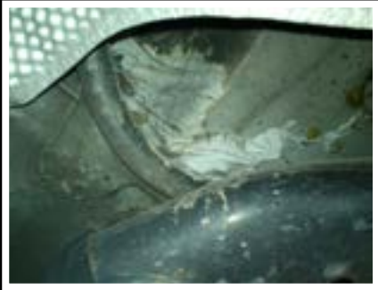
Den här "mattan" går längs med hela bilen. Allt för att täcka skarvarna mellan de olika delar som bilen är byggd av.
